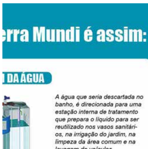
Foto 3.1. Sistema de tratamento de água cinza
